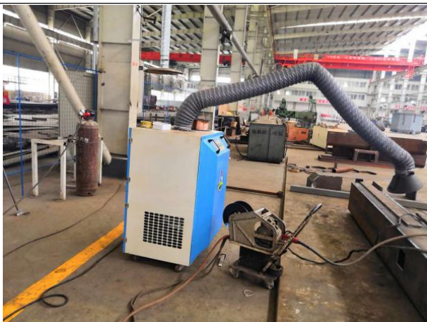
图 3-3 移动式焊接烟尘处理设备
